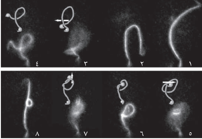
شكل ٥-٥: استُخدم الملقط البصري لربط هذه العقدة في خيط من الأكتين. عملت الخرزتان المجهريتان المتصقتان بكلتا نهايتي الخيط «كمقبضين»، وقد تم إظهار الأكتين للعيان تحت المجهر بتسليط الضوء الساطع عليه لجعله متألقاً.
