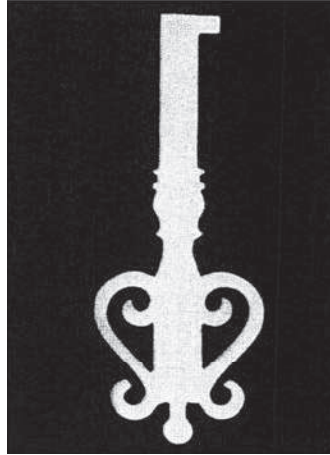
شكل ٢١-٢: رسم مجازي لهيكل مفتاح استخدمه رونتجن كفصل كتاب، تم إنتاجه بأشعة إكس على فيلم فوتوغرافي كان يوجد تحت الكتاب.
