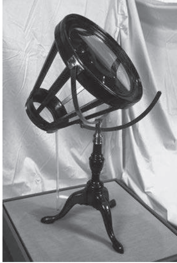
شكل ٧-٢: العدسة الحارقة التي استخدمها بريستلي.
