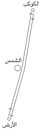
شكل ٢-١٣: اختبار للنسبية العامة مبني على التأخير الزمني لنبضات الرادار المرتدة من أحد الكواكب بينما تمس النبضات حافة الشمس.
