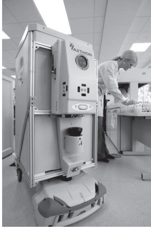
شكل ٢-٢: الروبوت تج من شركة أيثون لنقل المعدات في المستشفيات
