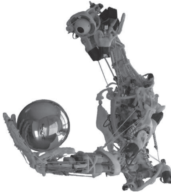
شكل ٤-٦: كرونوس، روبوت يشبه البشر ويحاكي حركاتهم الجسدية
