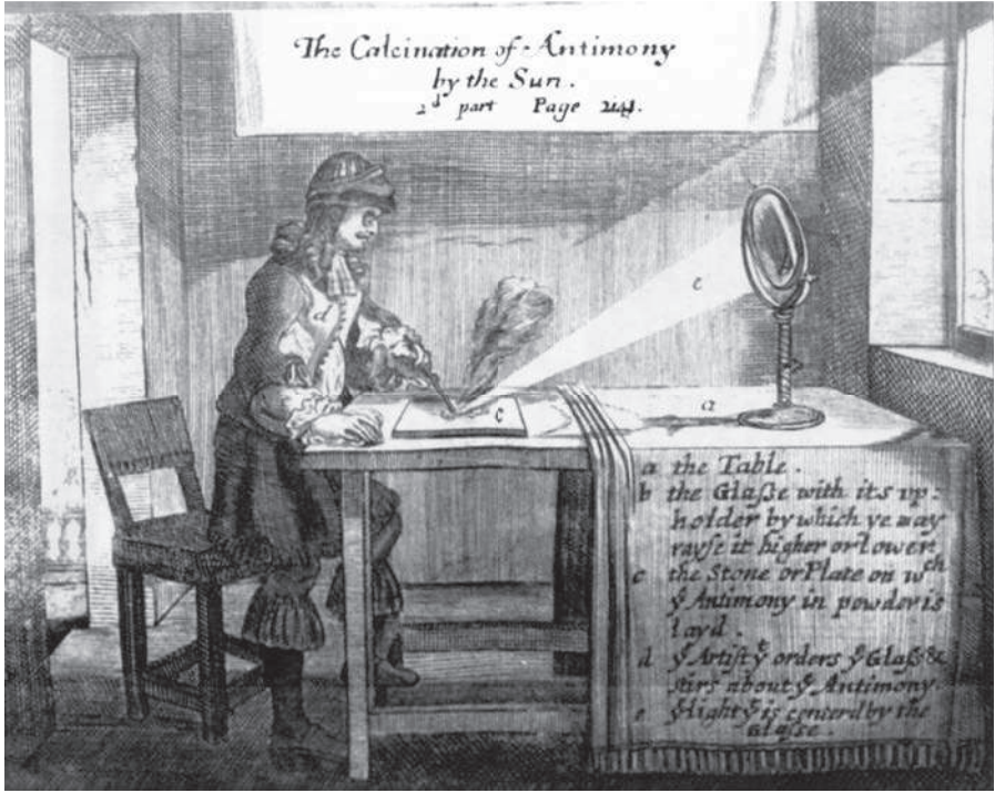
شكل ٣-٧: تكليس الأنثيمون باستخدام «النار السماوية» (من كتاب لوفيفر (١٦٧٠) «الدليل الشامل في الكيمياء»)، كان لوفيفر من أوائل الكيميائيين الذين اكتشفوا أن الكلس يكون أثقل من المعدن النظير.
